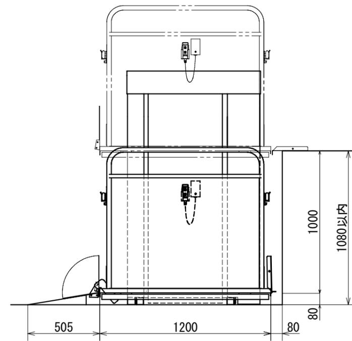
全体構造据付図 (DA-100Ad) 遮断棒付き
