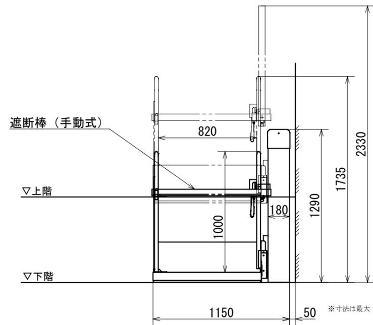
全体構造据付図 (DA-65Ad 右駆動)
